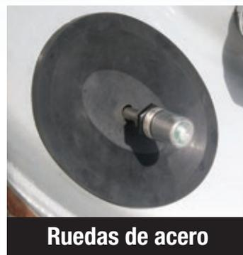
El desgaste del vástago de la válvula es peligroso
