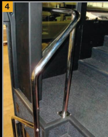
Un fabricante líder de Specialty Vehicle necesitaba un mejor diseño para las barandillas interiores. El reto era producir un producto de mejor calidad mientras se reducían sus costos. El equipo del proyecto superó las expectativas y ahora las partes se usan en cientos de vehículos. Las partes adicionales de los vehículos con acero inoxidable tubular doblado han sido desarrolladas desde entonces para muchos de sus proyectos de alto perfil.
