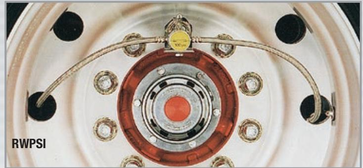
Permite que el aire fluya entre las dos llantas e iguala la presión con el sistema de monitoreo e igualador de presión de llanta Crossfire. Esto ayuda a reducir el desgaste y desgarro en las llantas y simplifica el mantenimiento de la llanta ahorrándole tiempo y dinero. Compatible con todo tipo de ruedas.
