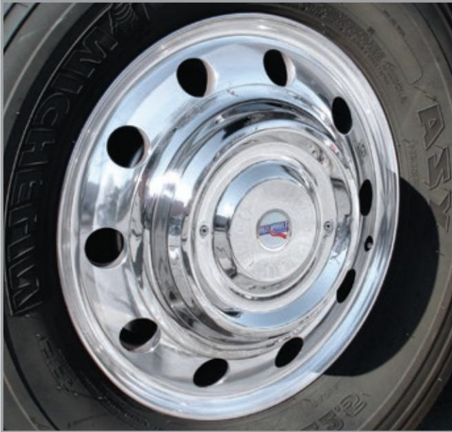
¡Estos tapacubos "Cover-Up" de bajo perfil son el único sistema que cubre el eje y las tuercas y presenta el soporte patentado "Wedge Lock"! Cubrir el cubo y las tuercas ayuda a aerodinamizar sus ruedas frontales para reducir el arrastre y mejorar la aerodinámica. Facilita la limpieza de las ruedas, no hay que lavar alrededor de las tuercas.
